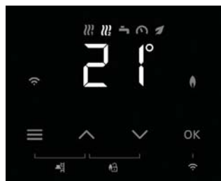
LED displej se 7segmentovým zobrazovačem a dotykovými tlačítky.
